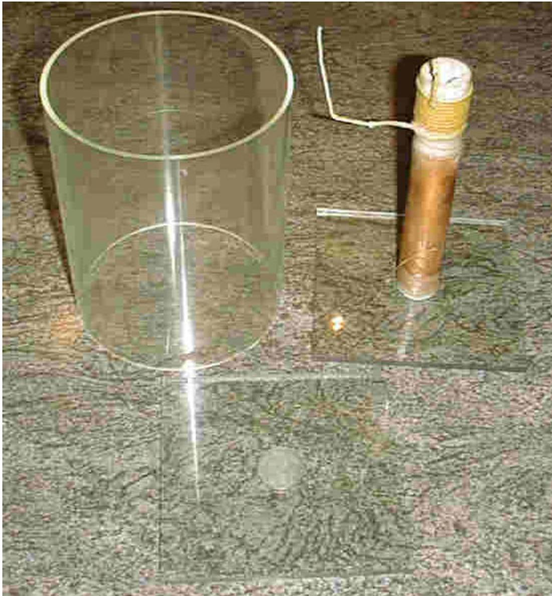
Ich habe die Keramikspule in die eingedrehte Vertiefung der Kunststoffscheibe gesteckt, sie passt wunderbar. Die beiden Außenplatten sind nicht aus Plexiglas, sondern aus unzerbrechlichem und viel hitzebeständigerem Macrolon angefertigt worden. Das Rohr besteht allerdings aus Plexiglas. (Die farbigen grünlichen Farbschattierungen im Plexiglas entstanden durch die starke Komprimierung des Bildes, um die Ladezeit zu verringern.)
