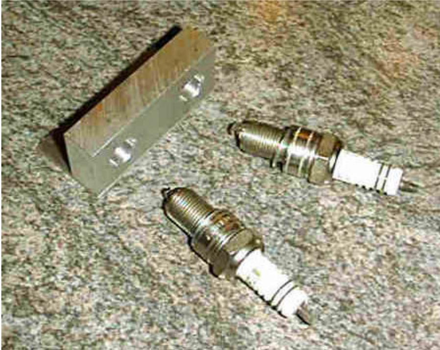
Ein Aluminium-Block, darunter eine Alu-Platte als Bodenblech zum Befestigen. Im Block zwei Bohrungen mit 14-mm- Feingewinde angebracht, in die die beiden Zündkerzen geschraubt werden.
